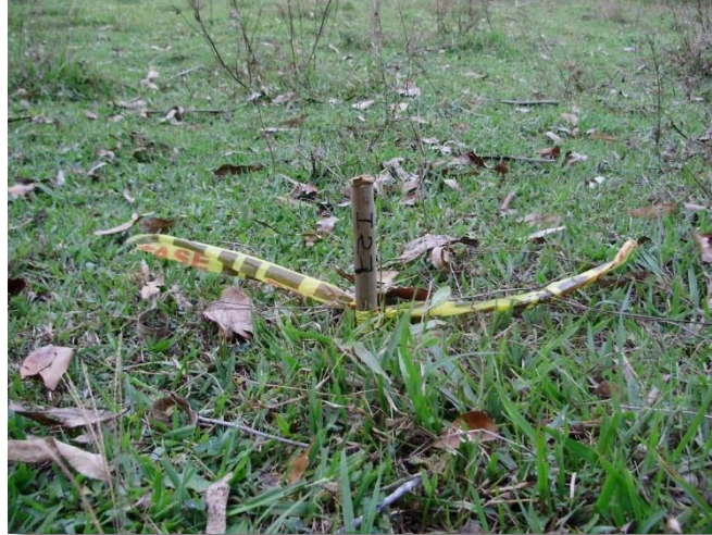
Foto 23. Taco localizado con Rover.
