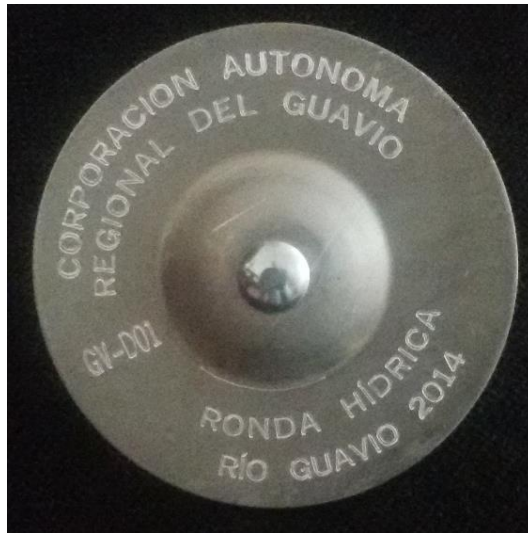
Foto 33. Detalle del anclaje de la placa de aluminio que se ubicó en los mojones.
