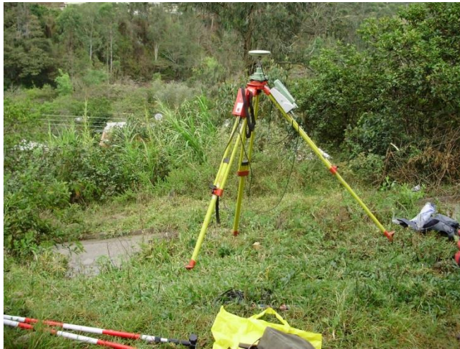
Foto 21. Equipo GPS estacionado en auxiliar # 4.
