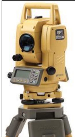
Figura 16. Estación total TOPCON GTS233W.
