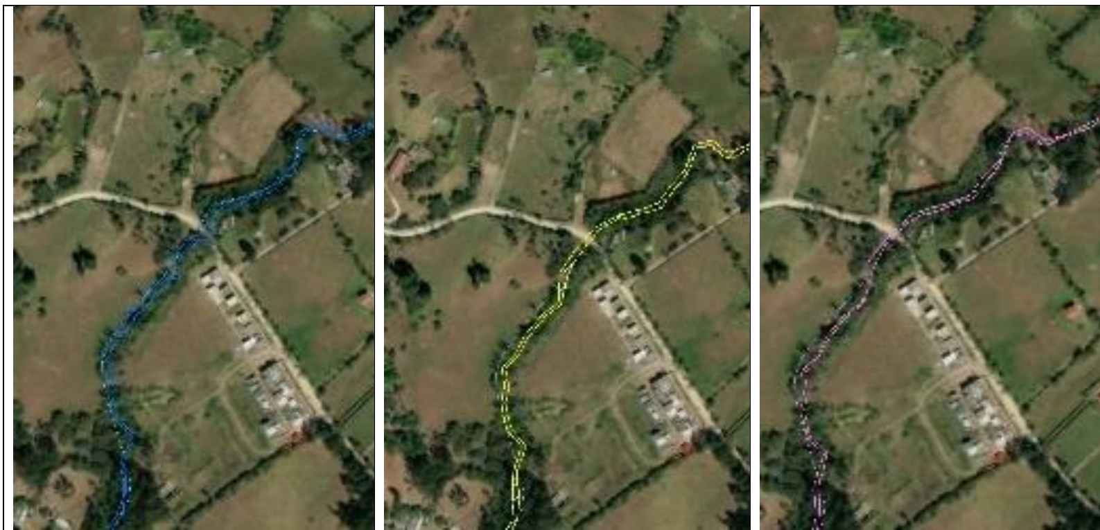
Figura 81. Delimitación del Cauce permanente 2007 - 2011 - 2019 ampliación a urbanización La Esperanza
